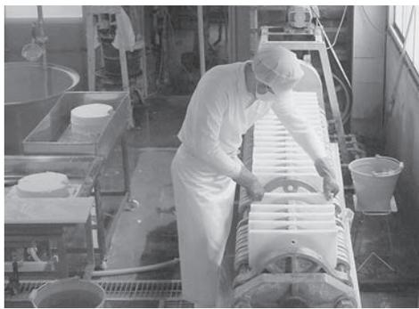
アルミ鑄造製圧搾器 石臼で水と一緒に挽いた糯米を圧搾し、白玉塊にする
