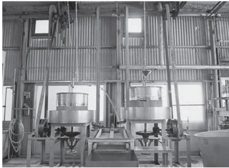
平ベルト式水挽き石臼機 2基（大・小）。石臼は石製、外容器はステンレス製、平ベルトプーリーは鉄製。歯車（直歯傘歯車）が付き、動力を用いて石臼を回転させ、原料の糯米を挽き、篩にかける
