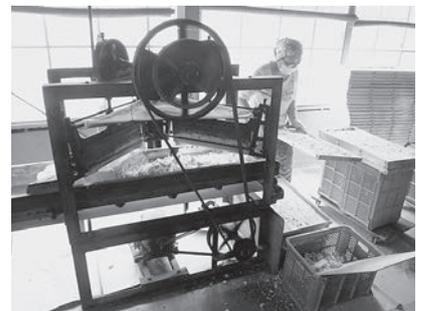
鋼製刻み機 圧搾した白玉塊を細かく刻む機材。ラチェット構造によるローラー稼働。クランク構造も白玉粉製造用に改良
