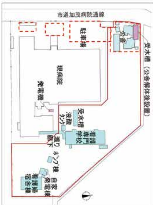
H27.6～ 附属建物解体・仮設(発電機等)工事
