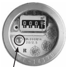
このマークが回っていたらどこかで漏水しています。すぐに修理の依頼をしてください。
