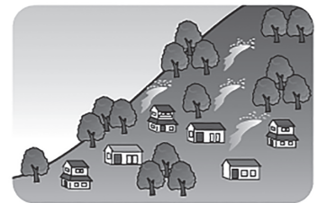
③ 斜面から水が噴き出す
