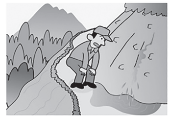
③ 斜面から水が噴き出す
