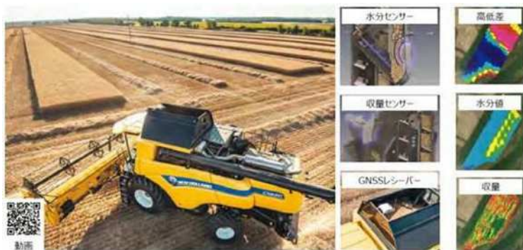
<収量・水分センサー付きコンバインによる作物収穫>
