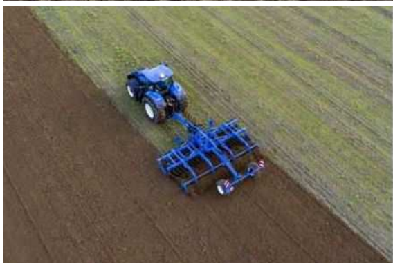
▲自動操舵により正確に耕された圃場
