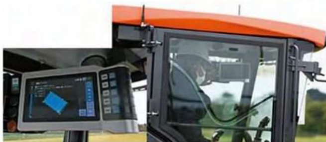
▲外周3周を手動で刈り取り、マップを作った後、ボタンを押すことで自動運転作業を開始する
