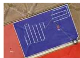
可変散布の飛行経路は自動生成
