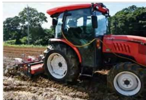
▲直進中、手放して作業できるため、振り返って後方の作業機の状態を確認できる。
