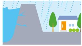
大雨などにより川の水が堤防いっぱいまで増えると、堤防に水の圧力がかかり始めます。
