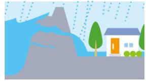
水が増え、水の力に堤防が耐えられなくなり、堤防の一部が崩れ始めます。
